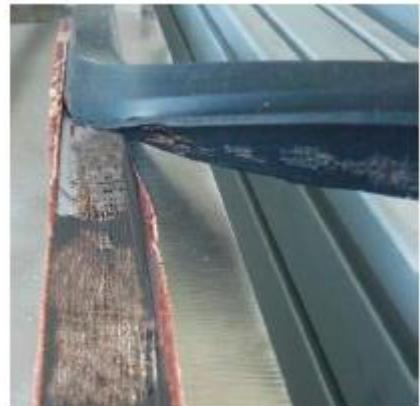
Традиционно скрепленные клинья других производителей могут отсоединяться от стальных лент при температуре +176°F (+80°C).
